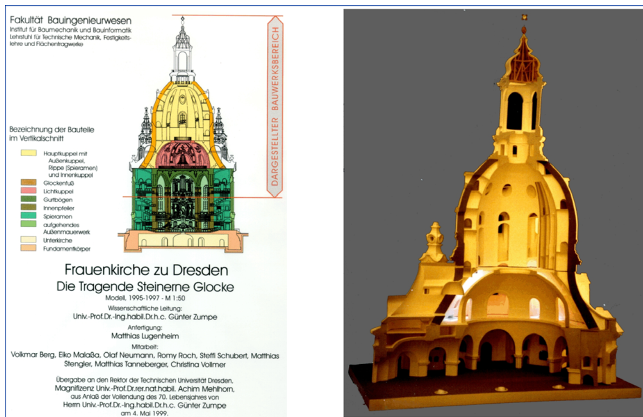
Bild A.11.4: Modell zur Vergegenständlichung der tragenden steinernen Glocke, Styrodur, M: 1:50, 1997, Bautafel und Ansicht. 13
