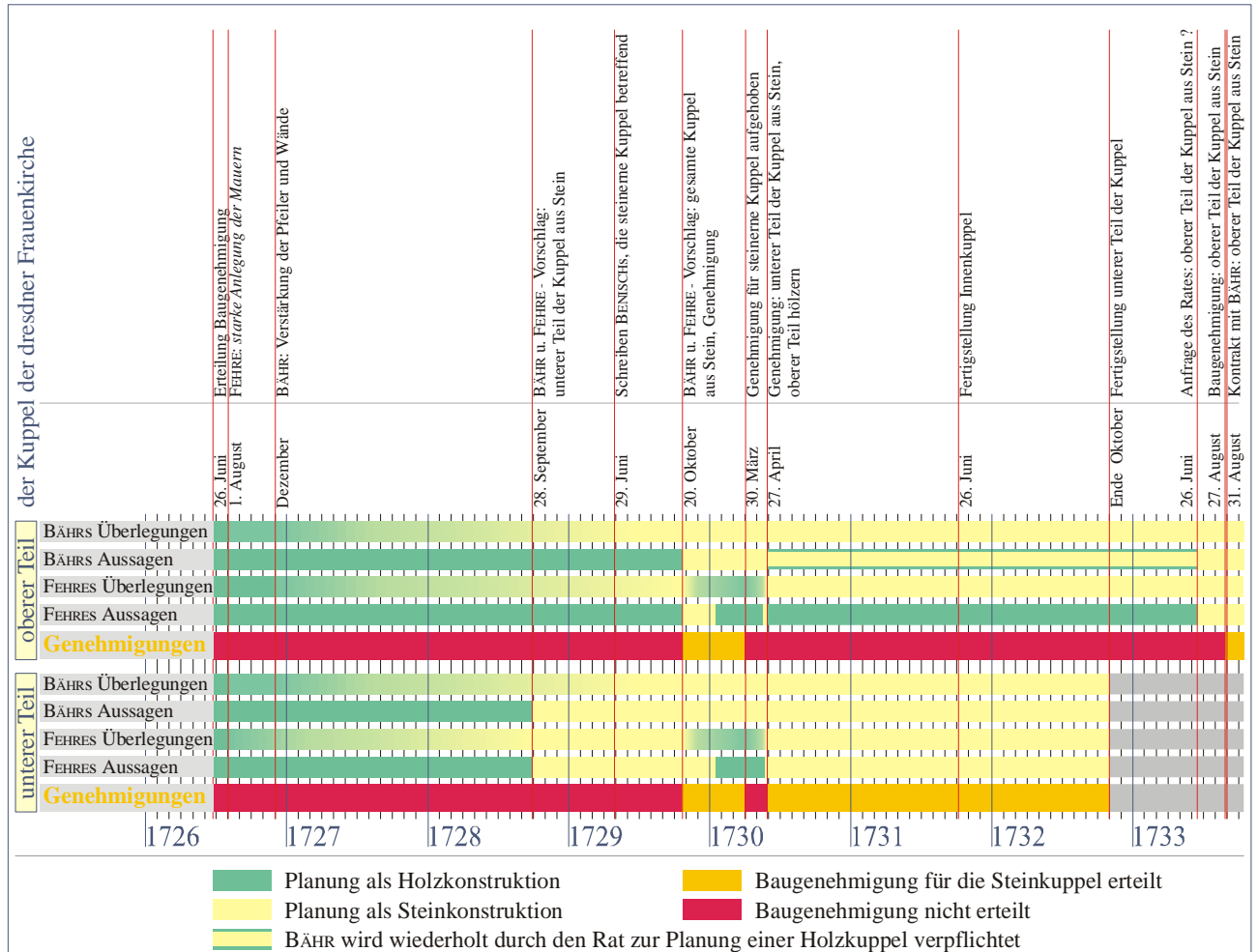
Bild 3.7.12: Zeitliche Abfolge der Planungsabsichten, der Planungsschritte und der Genehmigungserteilungen durch den Bauherrn für den Bau der Kuppel der dresdner Frauenkirche aus Stein.
